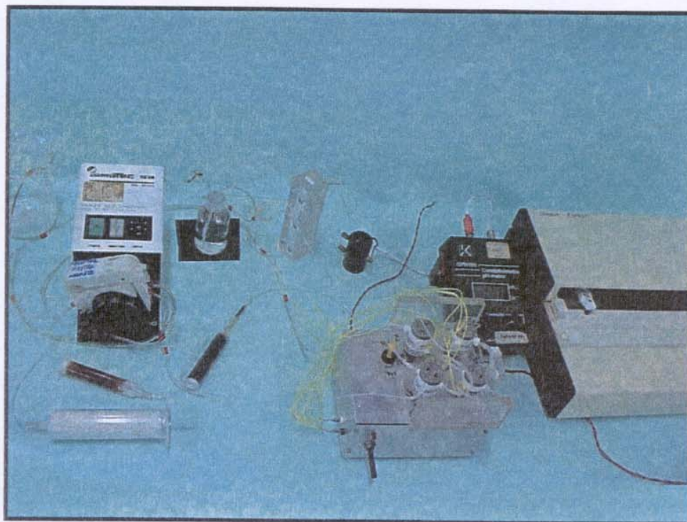
Figura 9: Foto do sistema FIA/Condutométrico para análise de \text{CO}_2 utilizando circuito fechado de fluido receptor, ar atmosférico como fluido carregador e sistema de injeção de amostra mecanizado.
