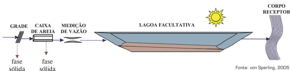
O esgoto afluyente entra em uma extremidade da lagoa e sai na extremidade oposta. Ao longo desse percurso, parte da matéria orgânica em suspensão tende a sedimentar, vindo a constituir o lodo de fundo, que sofre o processo de decomposição por microrganismos anaeróbios.
