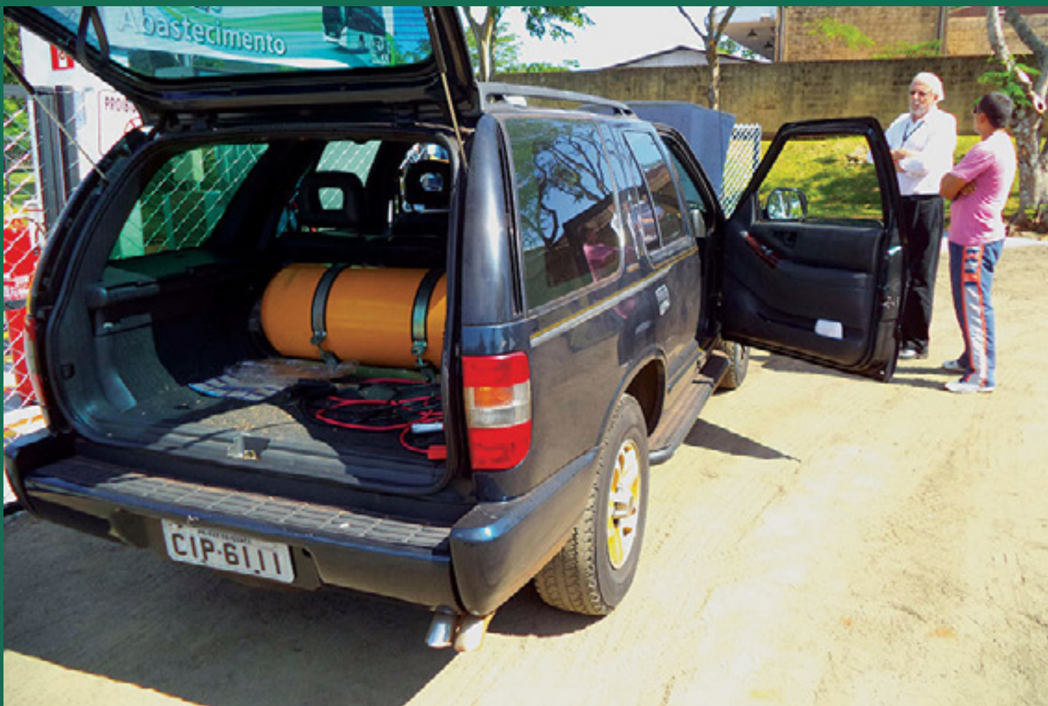
Cilindro de armazenamento de biometano em veículo particular
